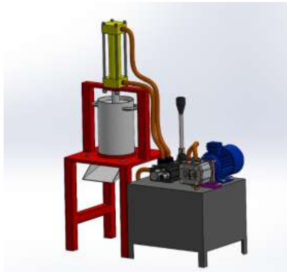
Gambar 1. Desain alat press sari jamu
