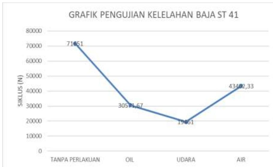
**Gambar 6.** Hasil pengujian kelelahan (*fatigue*) baja St 41
