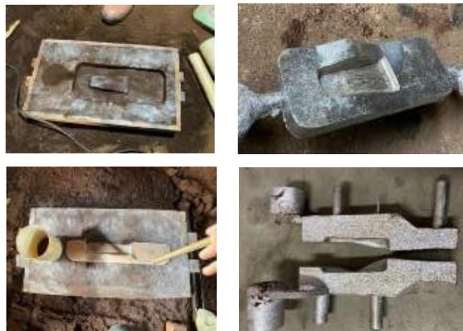
Gambar 5. Cetakan Pengecoran dan Hasil Pengecoran
