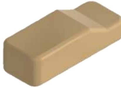
**Gambar 3.** Pola bahan cetakan permanen telapak kaki palsu
