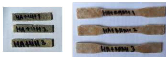
Gambar 4. Spesimen a) uji impact dan b) uji tarik
