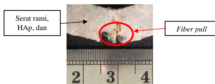
Gambar 10. Foto makro spesimen impak 6,5% SR:, 6,5% HAp: 87% UH
