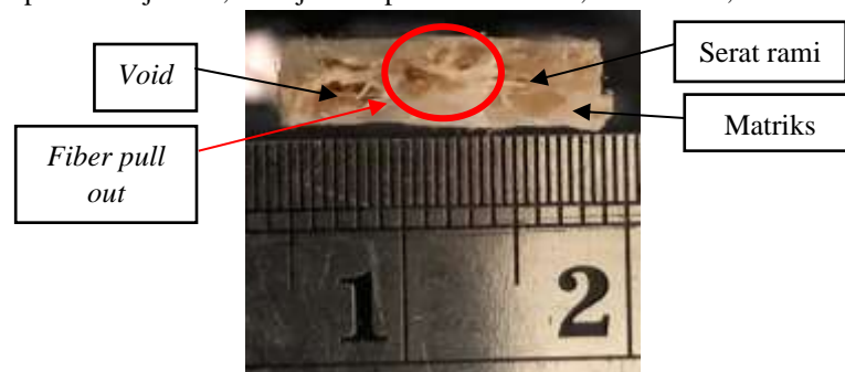
Gambar 12. Foto makro spesimen tarik 13% SR: 0% HAp: 87% UH
