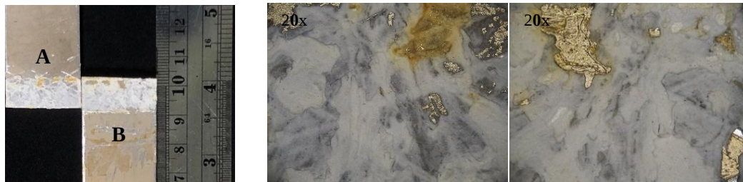
Gambar 10. Mode kegagalan spesimen 30% SF : 70% EP
