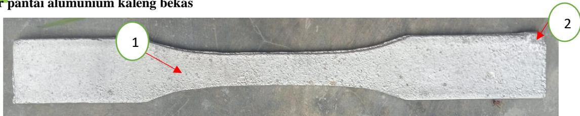
**Gambar 7.** Spesimen 1 Pasir Pantai, Aluminium Kaleng Bekas
