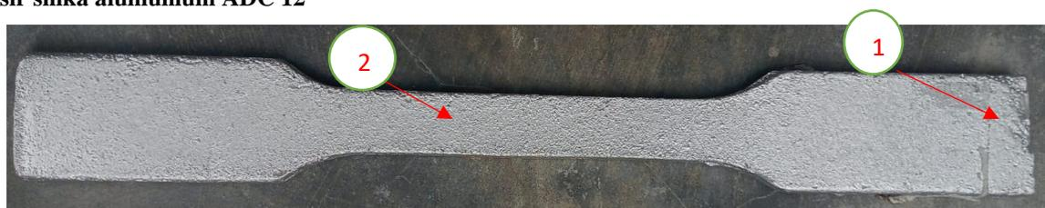
**Gambar 10.** Spesimen 1 Pasir Silika, Aluminium ADC 12
