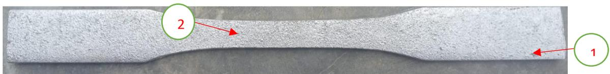
**Gambar 1.** Spesimen 1 Pasir Silika - Kaleng Bekas
