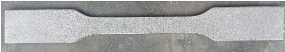
**Gambar 8.** Spesimen 2 Pasir Pantai, Aluminium Kaleng Bekas
