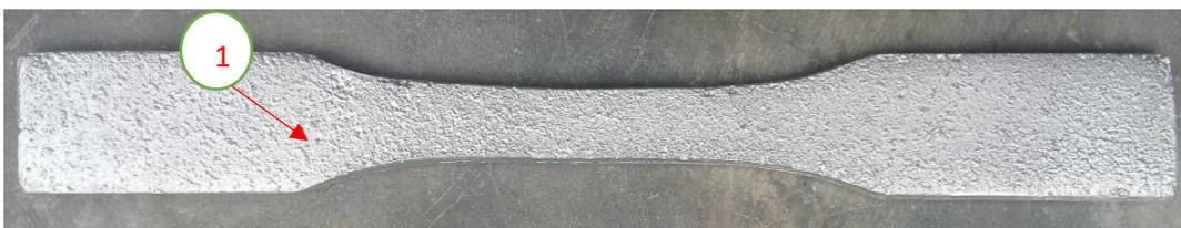
**Gambar 6.** Spesimen 3 Pasir Pantai Aluminium ADC 12
