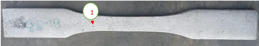
**Gambar 3.** Spesimen 3 Pasir Silika Kaleng Bekas
