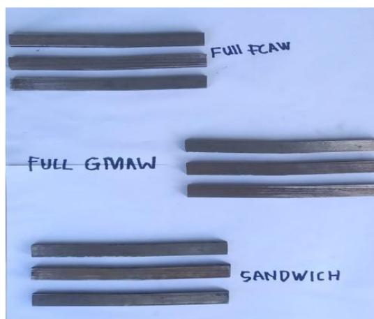
**Gambar 3.** Spesimen uji *bending* FCAW, GMAW dan kombinasi *sandwich* .
