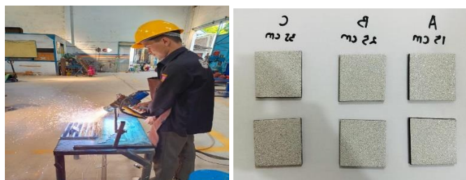
Gambar 2. Proses thermal spray dan hasilnya
