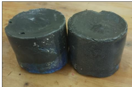
Gambar 1. Hasil Cetakan Sampah Jenis HDPE
