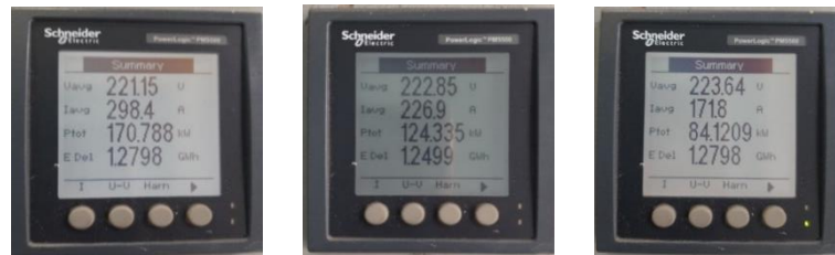
Gambar 2. Konsumsi energi dari set point 3,5°C, 5°C, 7°C (Berurutan dari kiri)
