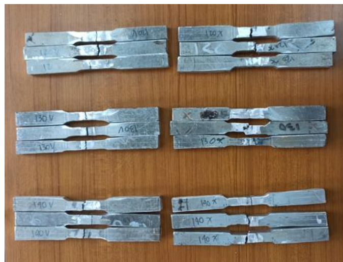
Gambar 2. Spesimen Uji Tarik Setelah dilakukan Tensile Test
