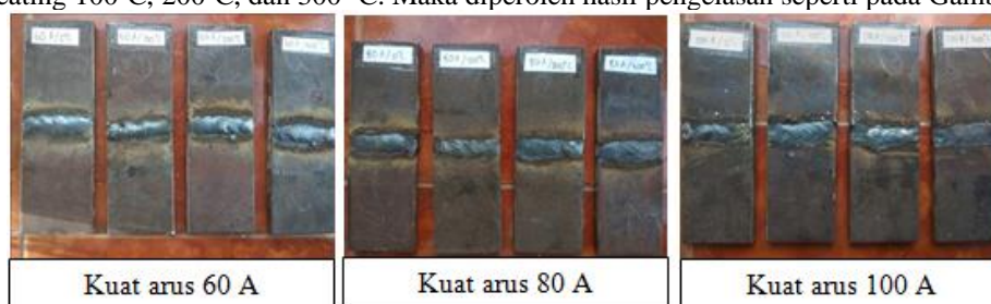
Gambar 3. Hasil pengelasan dengan kuat arus 60A,80A dan 100A dengan variasi tanpa preheating (temperatur ruangan 30°C), 100°C, 200°C, dan 300° C
