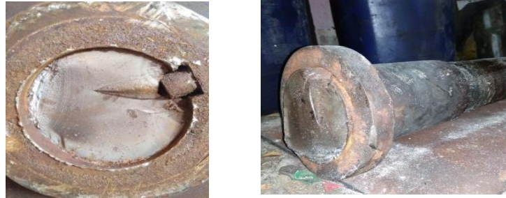
Gambar 2. Kegagalan yang terjadi pada poros sprocket
