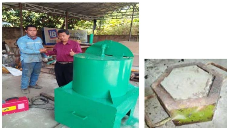
Gambar 14 Alat dan Hasil Paving block
